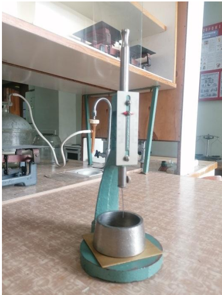
Прилад Вика для визначення нормальної густоти та термінів схоплювання цементного тесту
